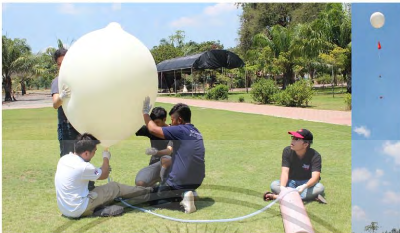
ภาพที่ 3.124 การบรรจุแก๊สฮีเลียมเข้าสู่บอลูนสำหรับส่งแบบจำลองทางวิศวกรรมของดาวเทียมคิวบแซท EM-2
