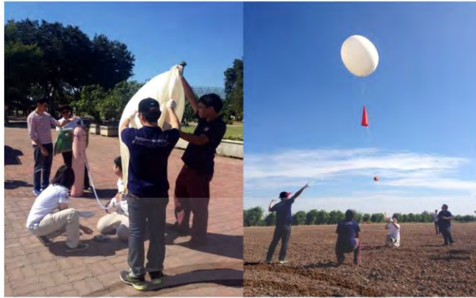
ภาพที่ 3.122 การประจุก๊าซฮีเลียมสูบลูกบอลสำหรับส่งแบบจำลองทางวิศวกรรมของดาวเทียมคิวบ์แซท EM-1
