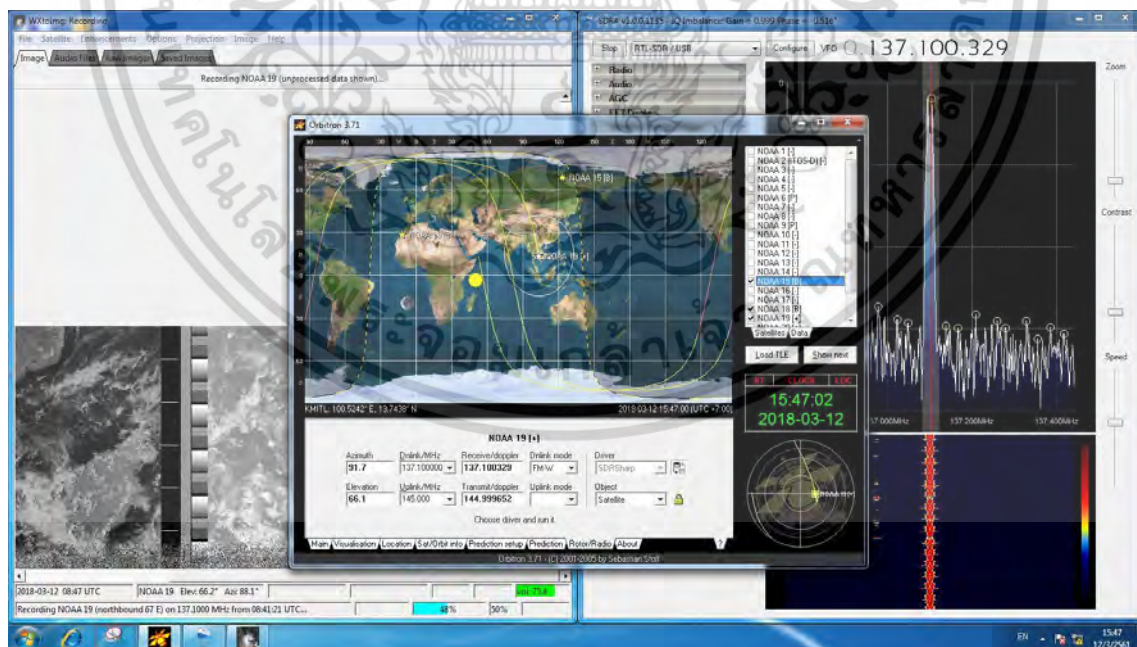
ภาพที่ 3.10 การรับและประมวลผลสัญญาณจากดาวเทียม NOAA 19
