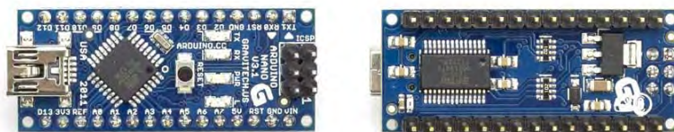
ภาพที่ 3.21 ไมโครคอนโทรลเลอร์ Arduino Nano
