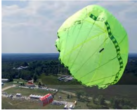
ภาพที่ 3.39 ร่มชูชีพแบบ Semi-spherical
