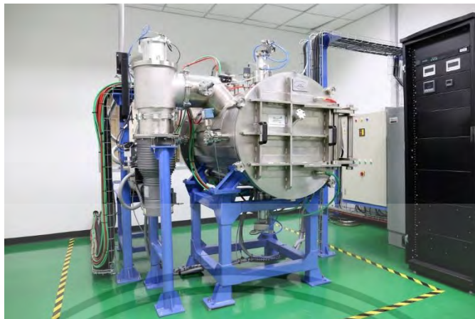
ภาพที่ 3.91 เครื่อง vacuum brazing furnace สำหรับจำลองสภาวะสุญญากาศ
