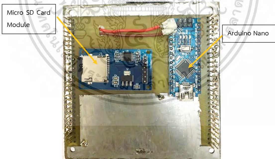
ภาพที่ 3.67 ลายวงจรส่วนควบคุมการถ่ายภาพ (ด้านล่าง)
