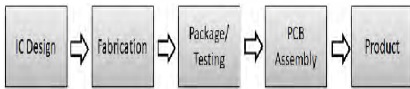
รูปที่ 3.15 ขั้นตอนที่เกี่ยวข้องก่อนจะได้วงจรจัดการพลังงานเป็น Integrated circuit (IC)
