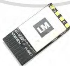
รูปที่ 3.25 โมดูล Bluetooth รุ่น LM910
