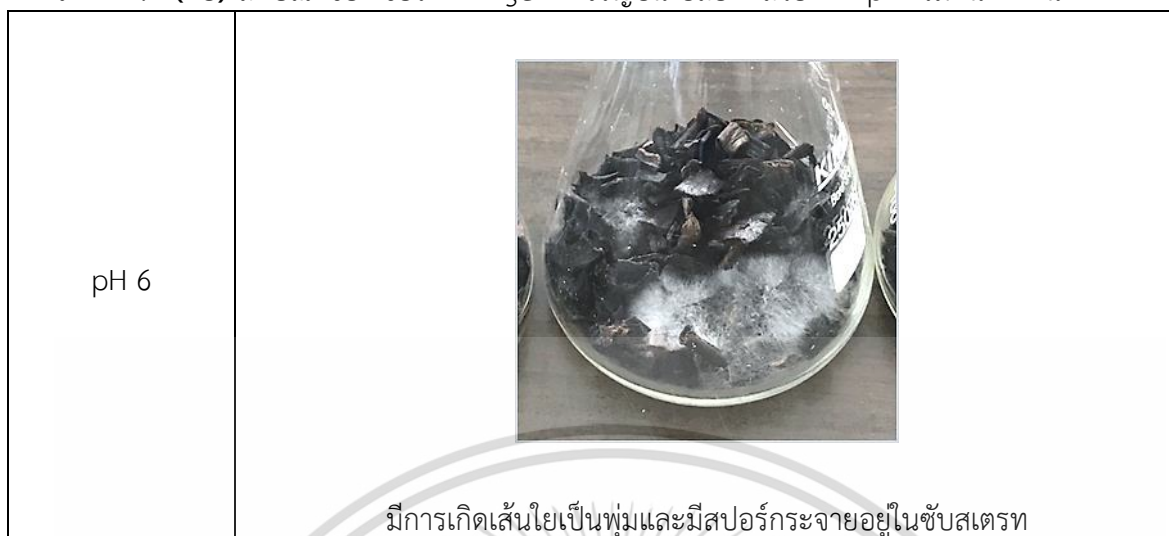
ตารางที่ 4.2 (ต่อ) ลักษณะของเชื้อรา A. niger ที่เจริญบนเปลือกกล้วยที่ค่า pH เริ่มต้นต่างกัน
