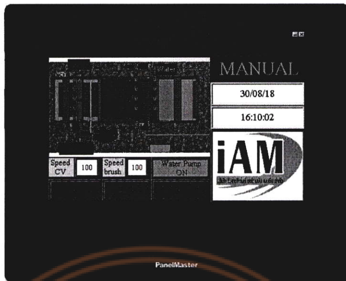
รูปที่ ก.18 การเปิดการทำงานของ Water Pump
