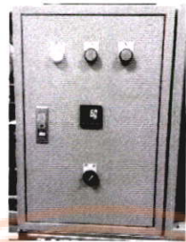
รูปที่ 3.9 อุปกรณ์วัดอุณหภูมิ ยี่ห้อ TOHO TTM-i4N
