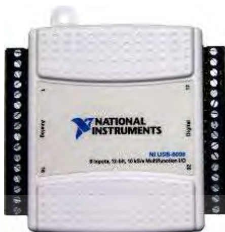
รูปที่ 3.4 Data Acquisition NI USB 6008
