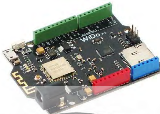
รูปที่ 6.5 ลักษณะและคุณสมบัติของบอร์ดไมโครคอนโทรลเลอร์รุ่น DFRobot WiDo : www.iot-store.com.au
