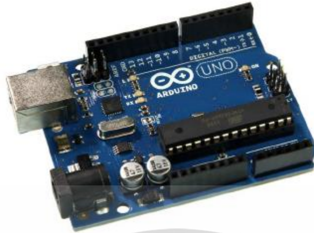
รูปที่ 3.14 อาร์ดูโน้ อูโน่ (Arduino Uno)
