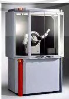
ภาพที่ 3.13 แสดงภาพถ่ายเครื่องเอกซ์เรดิฟแฟร็กโทรมิเตอร์ ยี่ห้อ Bruker รุ่น D8 Advance
