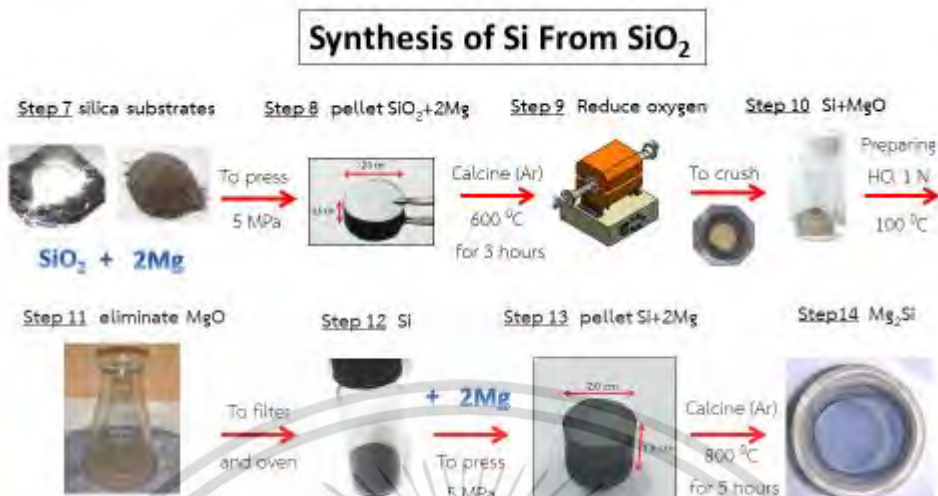
รูปที่ 3.9 ขั้นตอนการเตรียม Mg 2 Si
