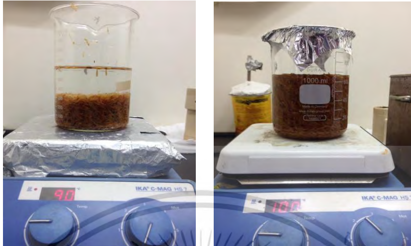
รูปที่ 3.2 อุปกรณ์สำหรับการล้างแกลบด้วยสารละลายกรดไฮโดรคลอริก
