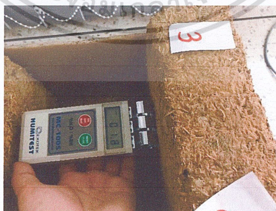
รูปที่ 3.15 การตรวจวัดค่าความชื้นอิฐดินดิบผสมแกลบ สภาวะควบคุมตัวแปรในห้องปรับอากาศ โดยเครื่องมือ Humitest MC-100S
