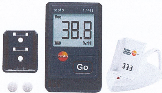
รูปที่ 3.30 เครื่องมือวัดผลการทดลอง Testo comfort 174H
