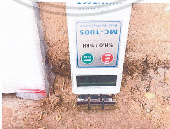
รูปที่ 3.36 การวัดความชื้นในวัสดุ ที่ฐานกล่องทดลองวิจัย ที่มา: ผู้วิจัย (2563)
