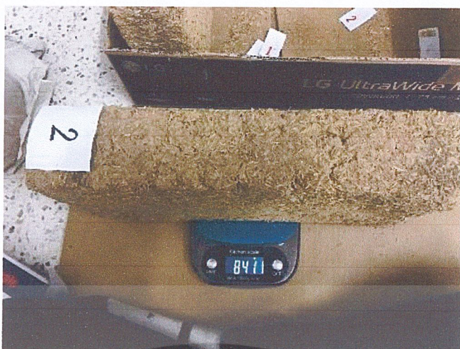
รูปที่ 3.11 การชั่งน้ำหนักก้อนอิฐดินดิบผสมแกลบก้อนที่ 2 ที่มา: ผู้วิจัย (2563)
