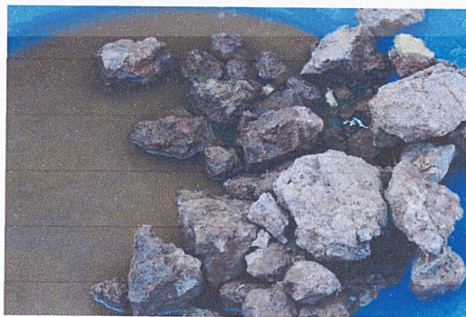
รูปที่ 3.6 การละลายดินเหนียวกับน้ำผสมทรายและเกลบ
