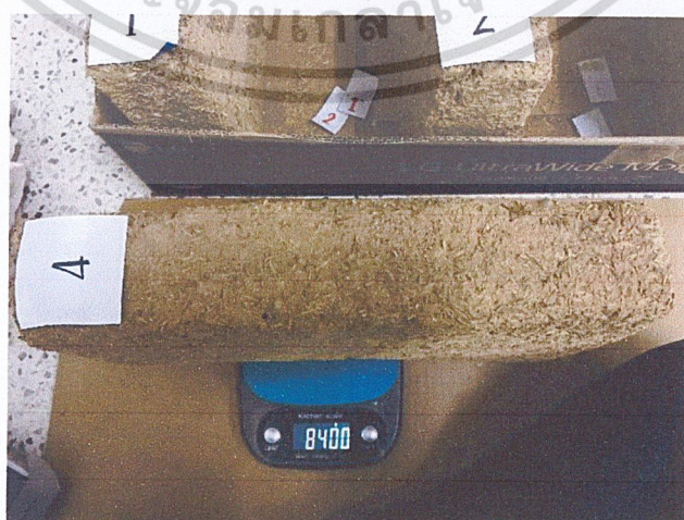
รูปที่ 3.13 การชั่งน้ำหนักก้อนอิฐดินดิบผสมแกลบก้อนที่ 4
