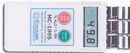
รูปที่ 3.33 เครื่องมือวัดผลการทดลอง Humitest MC-100S
