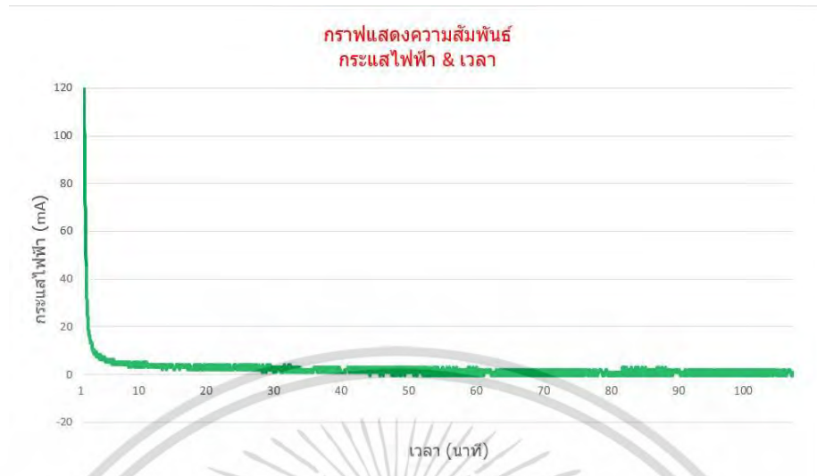
รูปที่ 4.36 กราฟแสดงความสัมพันธ์ของกระแสไฟฟ้าที่ค่าความต่างศักย์ที่ 25 โวลต์
