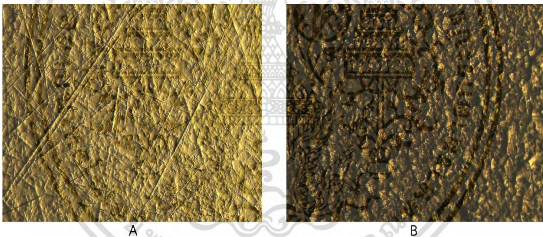
รูปที่4.40 แสดงพื้นผิวของชิ้นงานก่อนและหลังโอโนไดซ์ของชิ้นงานที่ค่าความต่างศักย์ที่30โวลต์
