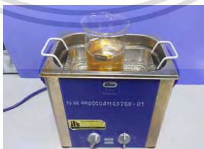
รูปที่ 3.4 แสดงภาพเครื่องอัลตราโซนิกขณะกำลังทำความสะอาดแผ่นโพลีอิมิดด้วยเมทานอล
