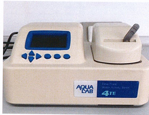
ภาพที่ ก.3 เครื่องวัดวอเตอร์แอกทิวิตี้ (Aqualab 4TE, Decagon Device, Inc., Pullman, WA, USA)
