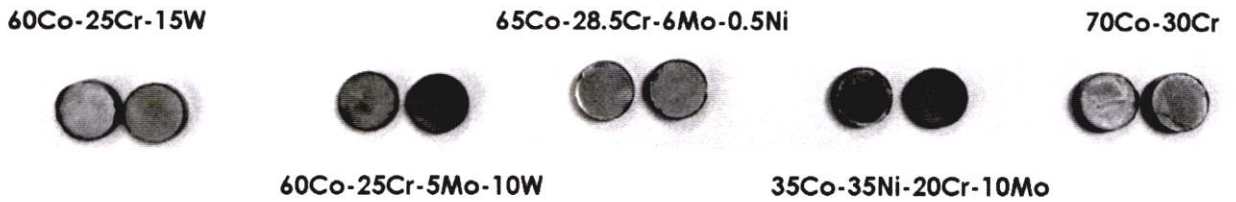
รูปที่ 3.7 เม็ดอัลลอยที่ผ่านการกดอัดแบบแกนเดียวร่วมกับการให้ความร้อนควบคู่ไปด้วย
