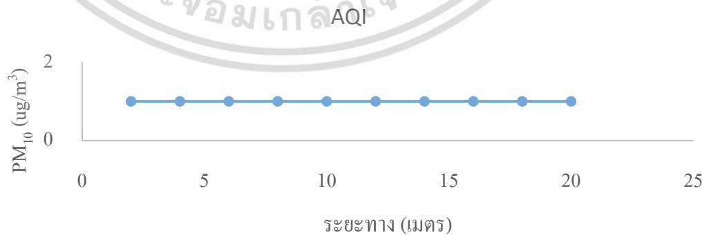
ภาพที่ 4.5 กราฟผลการวัดค่า PM 10 ที่ความสูง 5 เมตร
