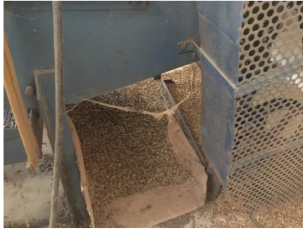
รูปที่ 2.31 เมล็ดสารกาแฟที่กระเด็นออกจากตะแกรงในระหว่างการคั่วแยก
