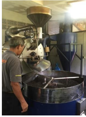
รูปที่ 2.24 กระบวนการคั่วเมล็ดกาแฟ
