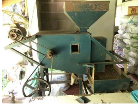
รูปที่ 2.21 เครื่องคั่วขนาดเมล็ดสารกาแฟแบบตะแกรงโยก
