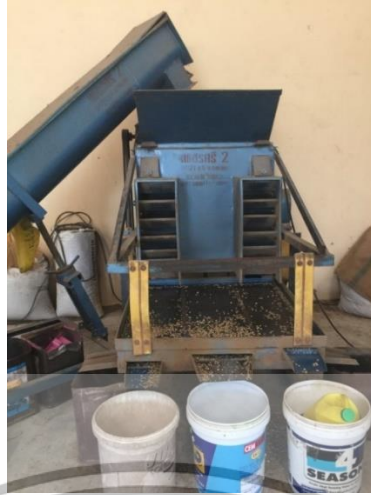
รูปที่ 2.28 เครื่องคัดแยกขนาดพร้อมกำจัดสิ่งปลอมปน
