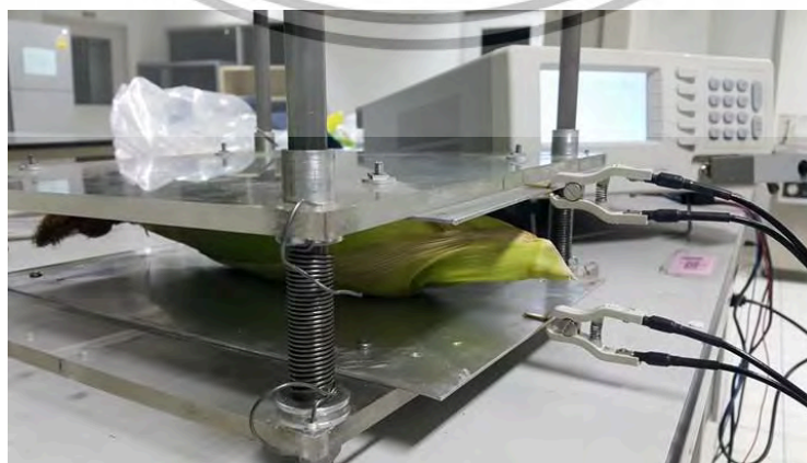
ภาพที่ 3.3 เครื่อง LCR800 ต่อกับแผงเหล็กยึดด้วยสปริง
