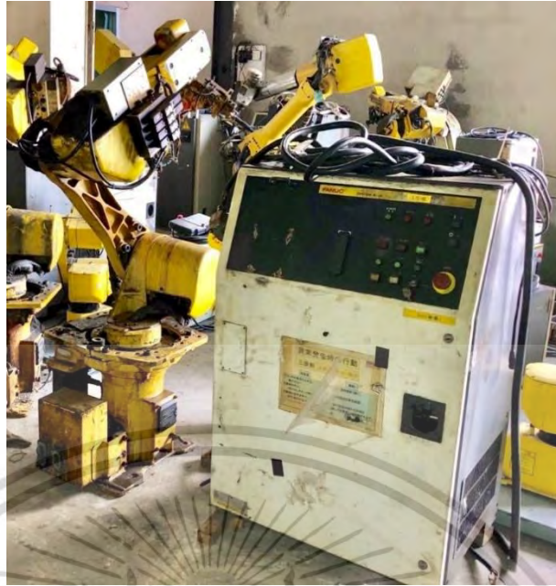
ภาพที่ 5.19 ตู้ควบคุมแขนกลและตัว "Fanuc" Robot รุ่น M-6i
