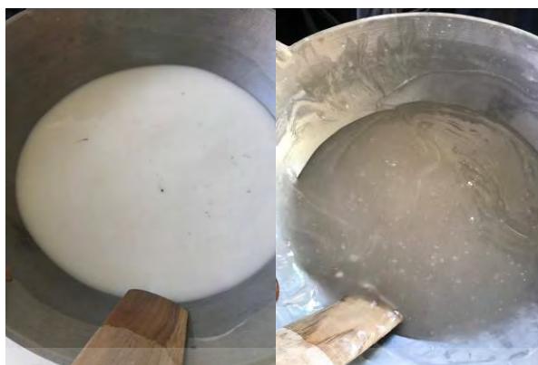
ภาพที่ 11.11 ลักษณะของกาวจากการตั้งไฟเคี่ยวจนใสพร้อมใช้งาน
