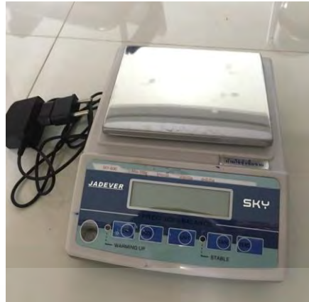
ภาพที่ 11.13 เครื่องชั่งไฟฟ้าทศนิยม 2 ตำแหน่ง
