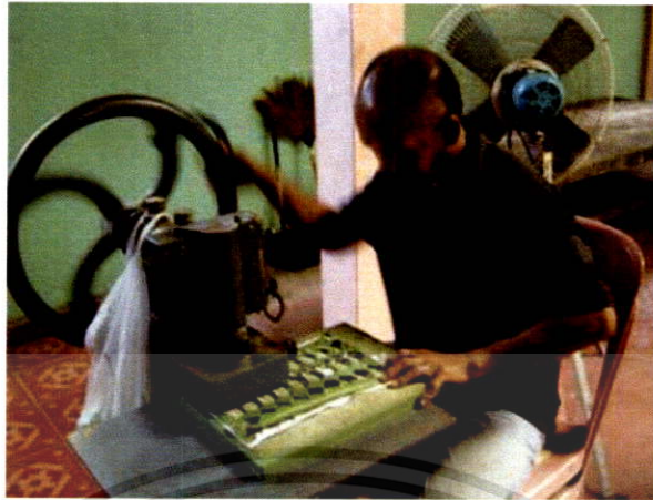
ภาพที่ 4.5 เครื่องตัดชิ้นส่วนกลีบดอกและใบ ที่มา: ถ่ายภาพโดยณัฐริกา กงสะกุล, 2552
