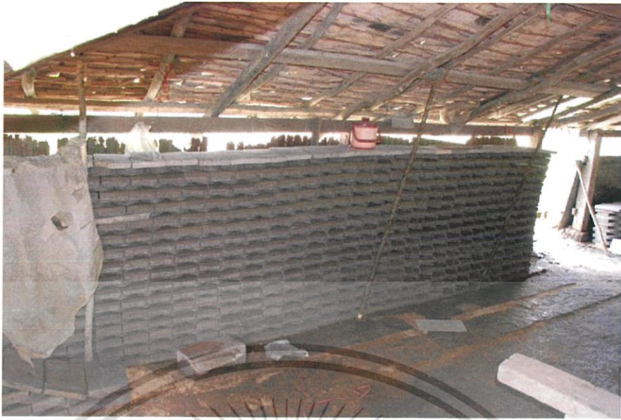
ภาพที่ 2.9 แสดงวิธีการเรียงกระเบื้องหลังจากที่ทำการตากแดดแล้วเพื่อเตรียมเข้าเตา ที่มา : ผู้วิจัย
