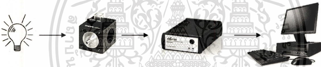
ภาพที่ 3.1.1 ไลอะแกรมการจับอุปกรณ์วัดการดูดกลืนแสง
