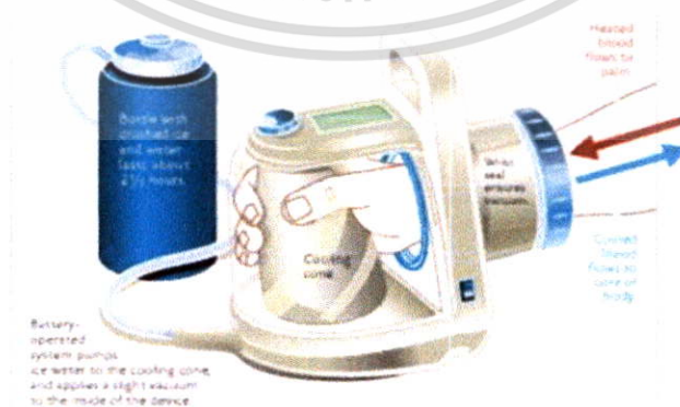
รูปที่ 2.10 เครื่อง Rapid Thermal Exchange (RTX) จากบริษัท AVAcore Technology [1]
