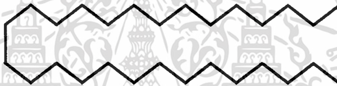
รูปที่ 2.1 โครงสร้างของพาราฟินแว็กซ์ (Octacosane, C_{28} ) [10]
