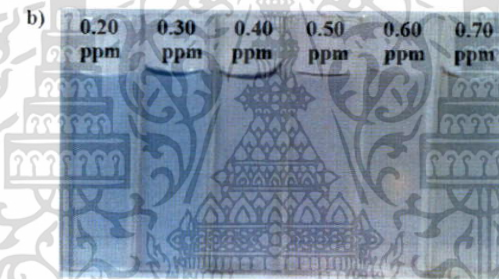
รูปที่ 4.12 สเปกตร้าแสดงค่าการดูดกลืนแสงของสารละลาย AgTNPs (a) และภาพแสดงสีของสารละลาย (b) เมื่อทำปฏิกิริยากับสารละลายมาตรฐานปรอทที่ความเข้มข้น 0.20 - 0.70 มิลลิกรัมต่อลิตร
