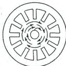
ภาพที่ 3.9 การวิ่งของอิเล็กตรอนที่โดนสนามแม่เหล็กไฟฟ้าทำให้เบี่ยงเบน
