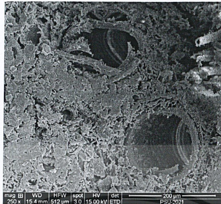
รูปที่ 5.16 ท่อลำเลียงน้ำหลังจากการอบ (ลมร้อน)
