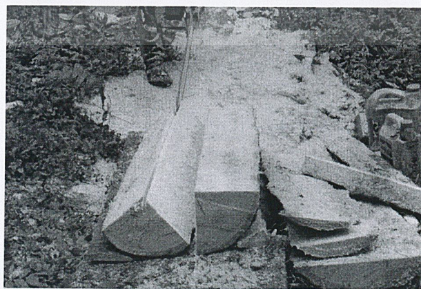
รูปที่ 4.18 ลักษณะการเลื่อยแบบ Cobweb Sawing
