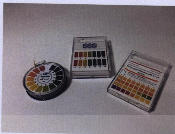
ภาพที่ 3.6 กระดาษยูนิเวอร์ซัลอินดิเคเตอร์
