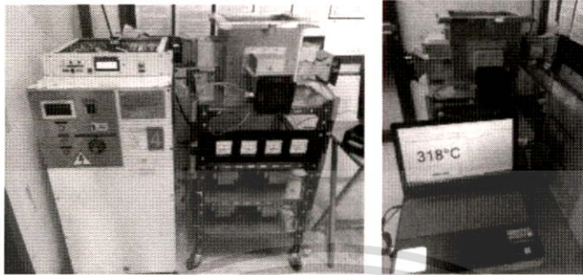
รูปที่ 3.25 ภาพโครงสร้างโดยของเตาไมโครเวฟ
