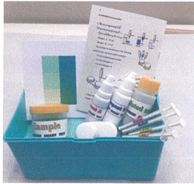
รูปที่ 4.7 แสดงชุดทดสอบภาคสนามสำหรับการหาปริมาณไนเตรตในน้ำดื่ม และตรวจวัดด้วย แอปพลิเคชันในโทรศัพท์มือถือ
