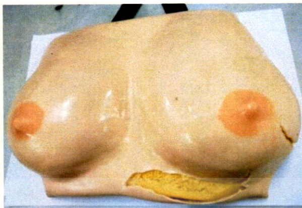
ภาพที่ 1.4 ผิวยางซิลิโคนที่เกิดการฉีกขาดจากการใช้งานจริงของแบบจำลองฝึกตรวจมะเร็งเต้านมปีการศึกษา 2558
