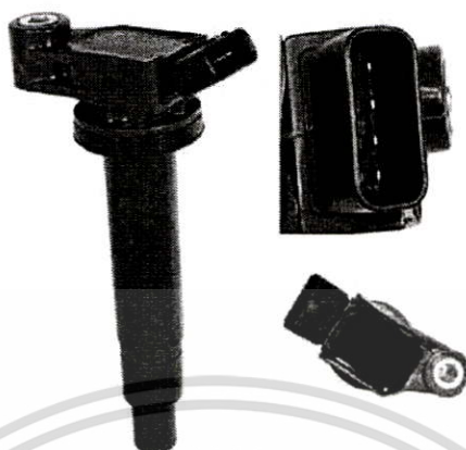
รูปที่ 2.25 คอยล์จตุระเปิดพร้อมกับวงจรขั้วกระแสที่ติดตั้งภายใน
