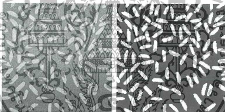
รูปที่ 3.20 การประยุกต์เทคนิคการทำเทรชโฮลด์ในการแยกภาพเมล็ดข้าวออกจากพื้นหลัง:
