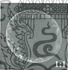
รูปที่ 5.4 พื้นผิวของชั้นรูปพรุนที่อัตราส่วนสารละลายกรดไฮโดรฟลูออริกต่อเอทานอลต่างๆ กัน
