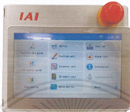
รูปที่ 3.14 หน้าหลักของ Touch Panel Teaching Pendant ของ IAI รุ่น TB-02
