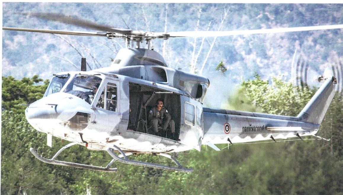
ภาพที่ 81 เฮลิคอปเตอร์แบบ Bell-412 ขณะทำการบิน
