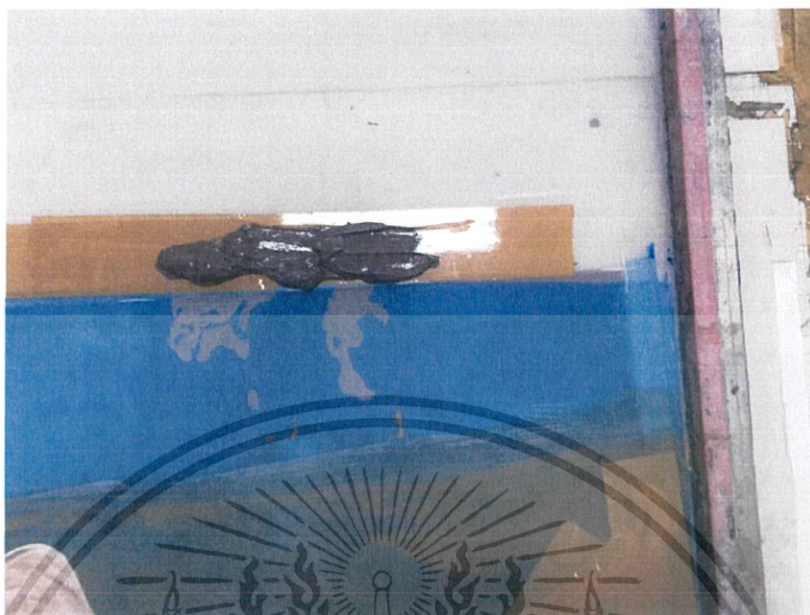
ภาพที่ 89 การวางสีพื้นหลังในน้ำหมึกเข้มสุด
