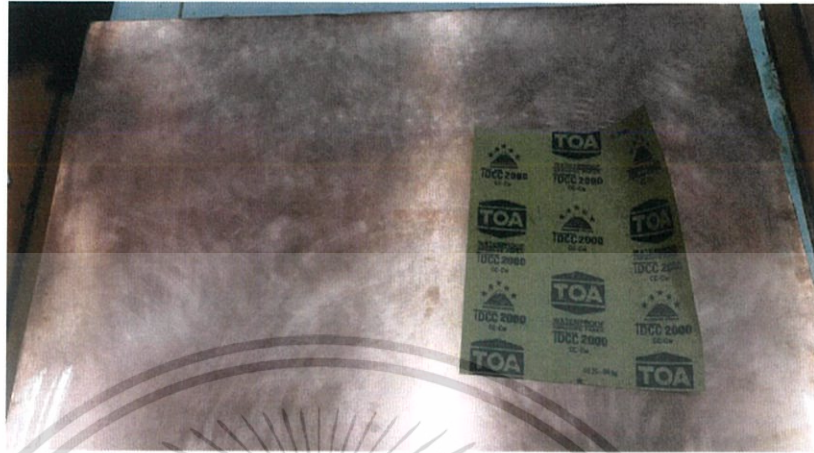
ภาพที่ 3.20 การขัดแม่พิมพ์ด้วยกระดาษทรายเบอร์ 2000
