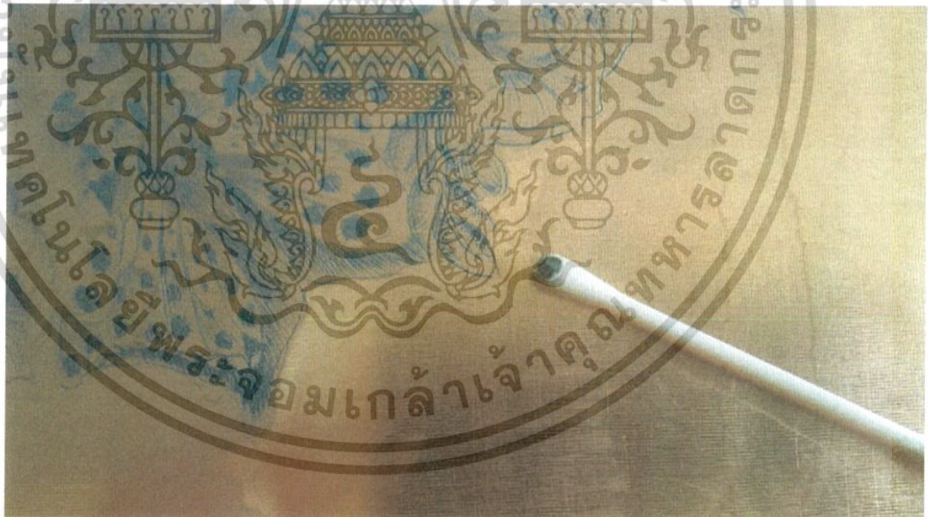
ภาพที่ 3.29 การเช็ดหมึกส่วนเกินด้วยสำลีพันไม้จุ่มทินเนอร์
