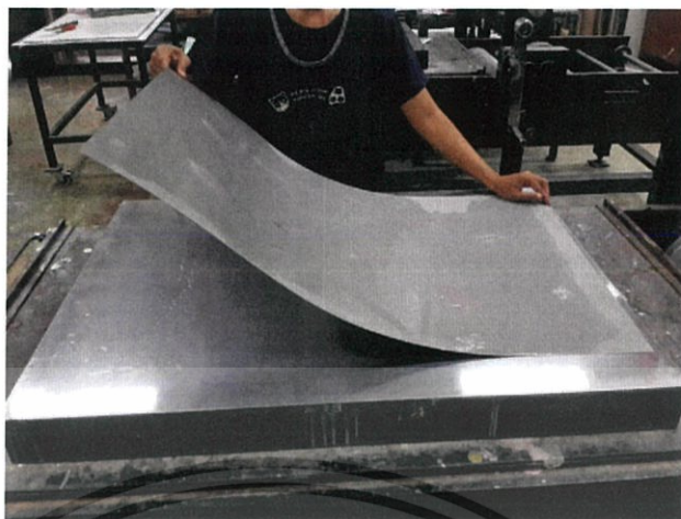
ภาพที่ 3.45 ผนึกเพลทเข้ากับแท่นพิมพ์ด้วยน้ำ
