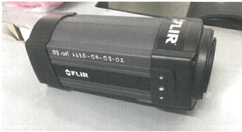
ภาพที่ 3.8 กล้องถ่ายภาพความร้อน (Thermal Camera) FLIR รุ่น A315
