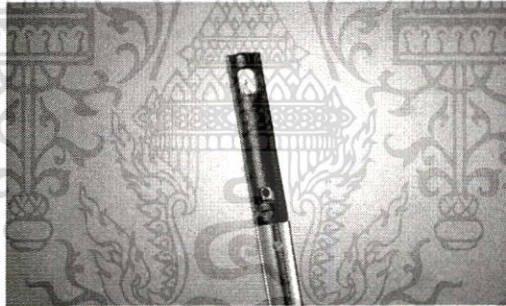
รูปที่ 2.5 หัววัดแบบลวดความร้อน (Thermal Probe)
