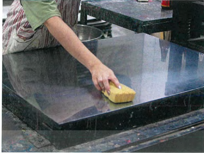
ภาพที่ 3.50 ภาพการใช้ฟองน้ำถูบนแท่นพิมพ์
