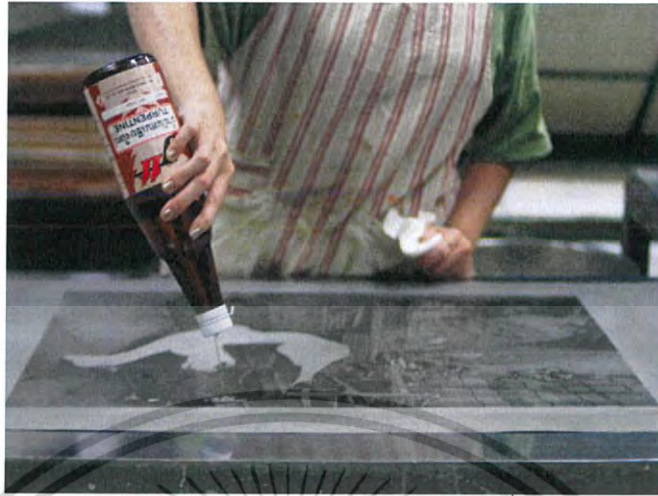
ภาพที่ 3.52 ภาพการทำ Wash out ด้วยน้ำมันสน
