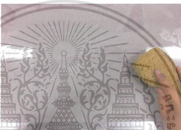
ภาพที่ 3.83 ทำความสะอาดหน้าเพลท
