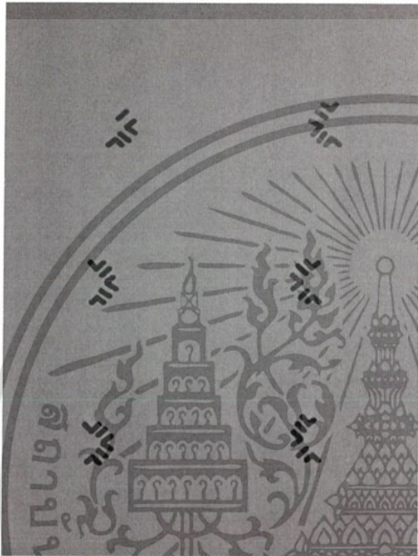
ภาพที่ 3.40 หน้าเพลทที่ถูกเขียน ด้วยปากกาหมึกแห้ง
