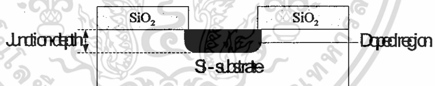
รูปที่ 4.12 แสดงลักษณะของสารเจือที่ได้จากกระบวนการแพร่สารเจือ
