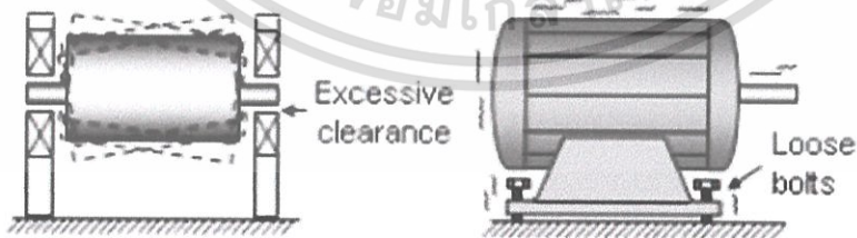
ภาพที่ 2.2 แสดงภาพชิ้นส่วนเกิดความหลวม [9] ที่มา : Commtest Instrument Ltd. “Beginner Guide to Machine Vibration”
