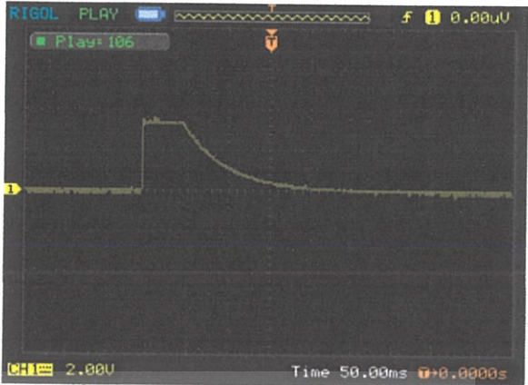
รูปที่ 4 ตัวอย่างไฟฟ้ากระแสตรงที่ออกจากรวมวงจรจัดการพลังงาน LTC3588-1
