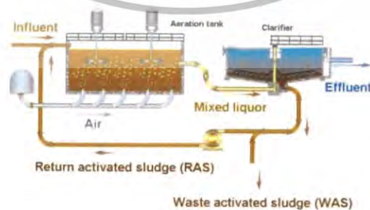
รูปที่ 7-4 แสดงการทำงานของระบบบำบัด
