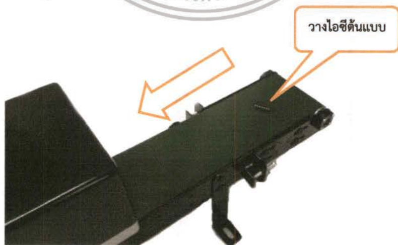
รูปที่ 3.15 แสดงการเคลื่อนที่ของสายพานลำเลียงไอซีต้นแบบเข้าสู่กล่องเก็บข้อมูล
