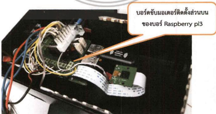
รูปที่ 3.6 รูปแสดงแผ่นวงจรส่วนขับเคลื่อนสายพานที่ออกแบบใช้งาน
