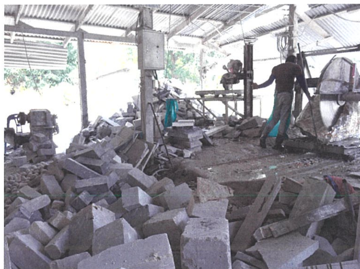
ภาพที่ 45 ภาพกระบวนการตัดหิน
