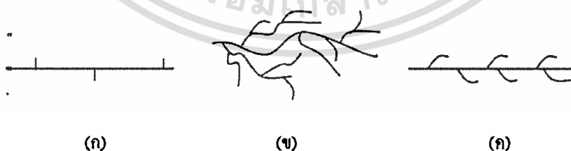
ภาพที่ 2.8 โครงสร้างของพอลิเอทิลีนชนิดต่างๆ โดย (ก) HDPE (ข) LDPE (ค) LLDPE
